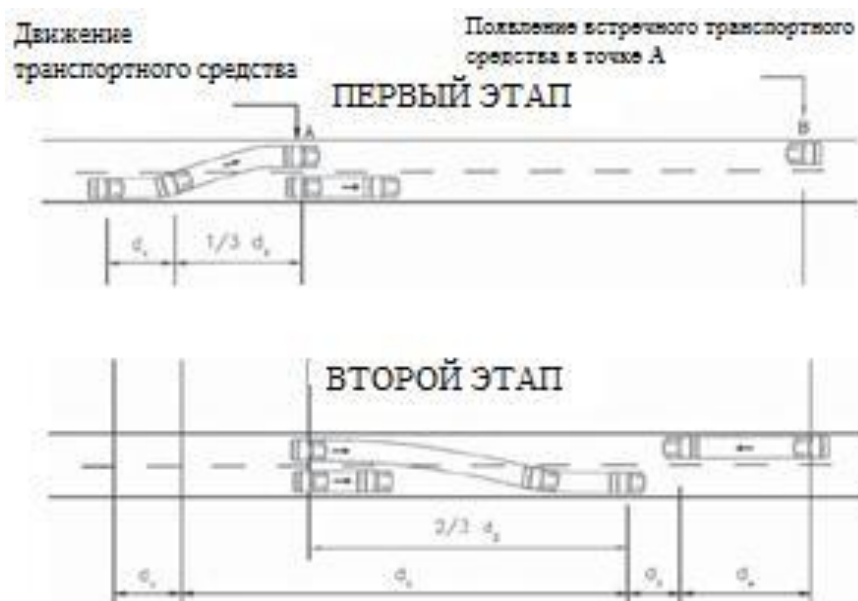
Рис. 15.7 Модель для определения расстояния видимости встречного автомобиля при обгоне
