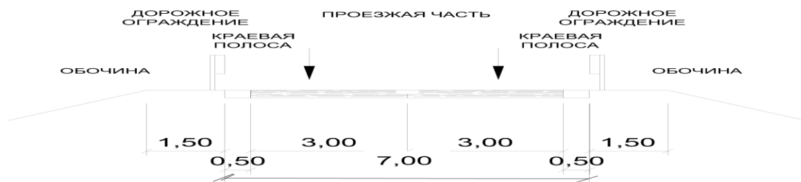
Рис. 14.20. Типовой поперечный профиль автодороги IV категории с 2 полосами движения
