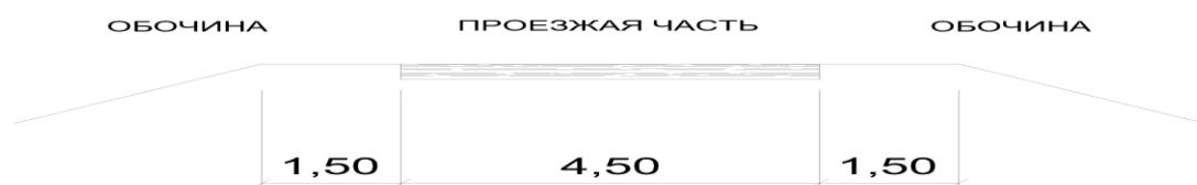
Рис. 14.21. Типовой поперечный профиль автодороги V технической категории
