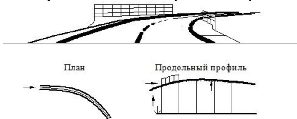
Рис. 13.16 Удачное расположение моста на криволинейном участке дороги.
