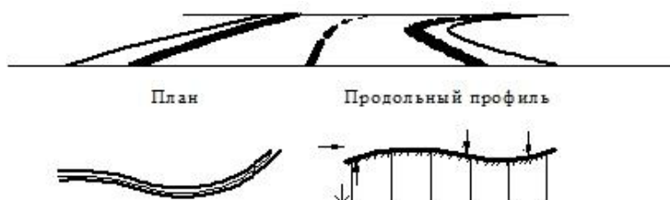
Рис. 13.18. Нарушение зрительной ясности дороги на участке с извилистым планом трассы и вертикальными кривыми малого радиуса.
