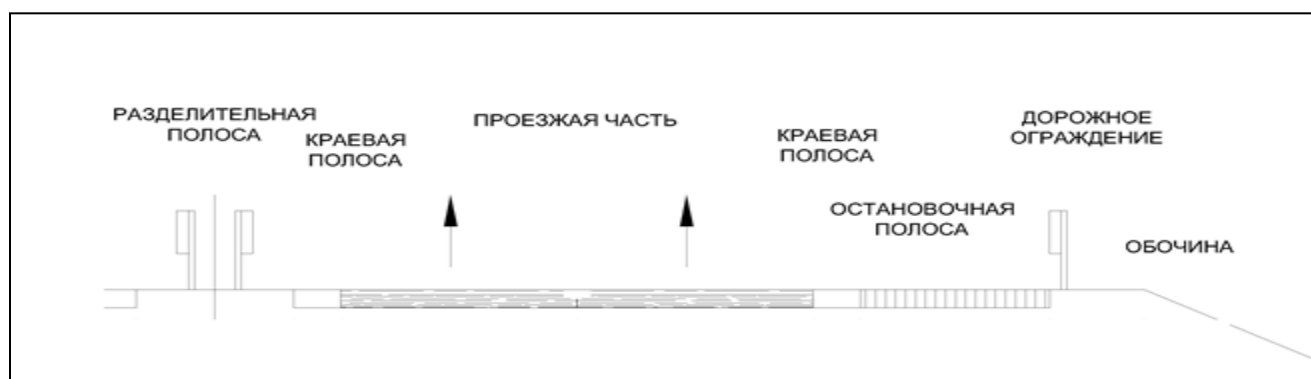
Рис 14.1 Основные элементы поперечного профиля дороги.
